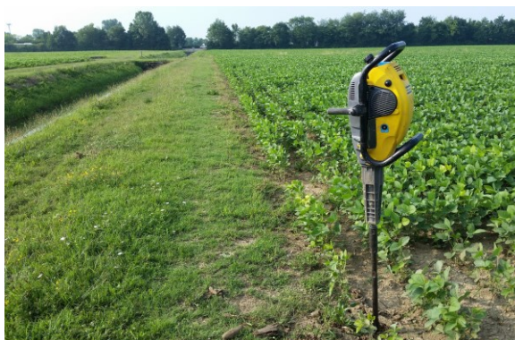
Fig. 4.1.1.A - Campionatore motorizzato
